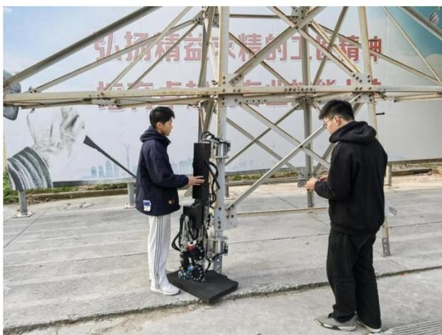
图 26 南通国网供电公司启东分公司“输电铁塔自动巡检装置”项目验收测试现场
